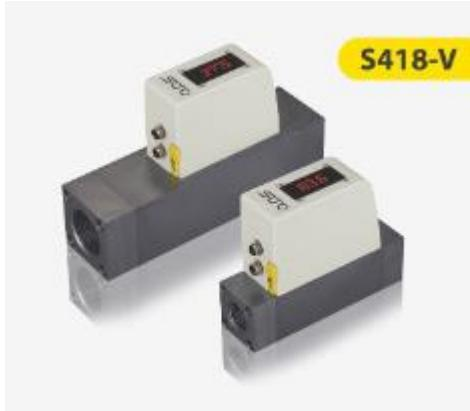
S418-V предназначен для контроля производительности вакуумных насосов. Этот поточный расходомер измеряет фактический расход и абсолютное давление на стороне низкого давления вакуумных насосов. Контролируя расход в точке использования, расходомер помогает оптимизировать эффективность вакуумной системы.
