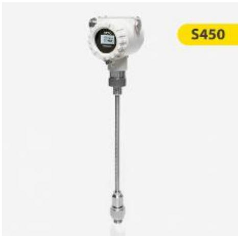
Расходомер SUTO S450 основан на принципе теплового массового расхода. Он измеряет объемный стандартный расход в широком диапазоне измерений. Результат не зависит от давления и температуры. Идеально подходит для измерения расхода и потребления сжатого воздуха.
