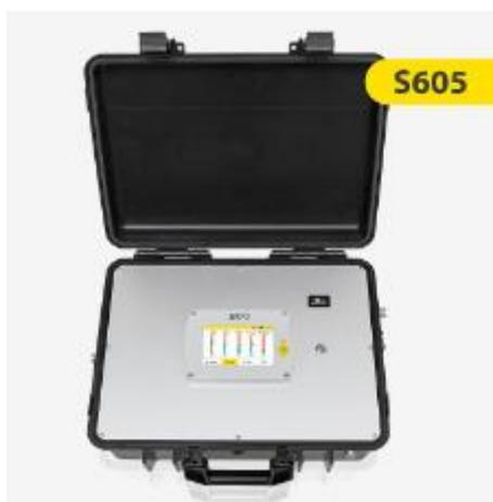
Портативный анализатор чистоты вдыхаемого воздуха S605 может измерять содержание O<sub>2</sub>, CO<sub>2</sub>, CO, точку росы и пары масла в выдыхаемом воздухе с высокой точностью. Регулярные проверки с помощью данного анализатора являются неотъемлемой частью безопасной работы.
